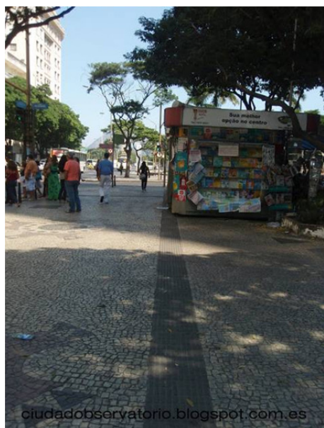
Fig. 12: Espacio peatonal en Río de Janeiro en el que el pavimento señalizador para los invidentes es interferido por un quiosco que se sitúa ocupando gran parte de él. A tener en cuenta que en esta imagen la franja amarilla señala este pavimento y no el espacio peatonal al completo.
