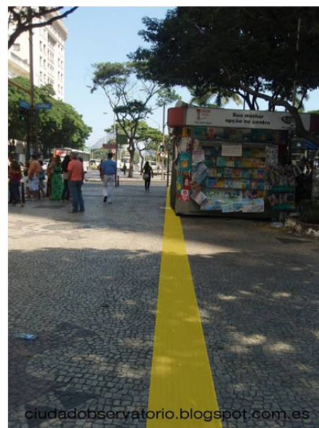
Fig. 12: Espacio peatonal en Río de Janeiro en el que el pavimento señalizador para los invidentes es interferido por un quiosco que se sitúa ocupando gran parte de él. A tener en cuenta que en esta imagen la franja amarilla señala este pavimento y no el espacio peatonal al completo.
